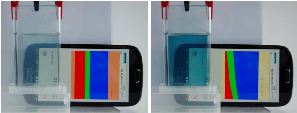
Abb. 14: Smartphone mit einem RGB-Sensor und einer App zur Messung der RGB-Werte; links: FTO-Glas mit Berliner Weiß; rechts: FTO-Glas mit Berliner Blau
