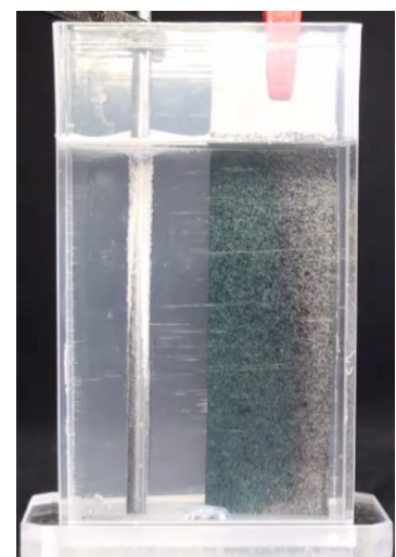
Abb. 2: Ladevorgang einer Dual-Carbon-Zelle. Links: Wasserstoffentwicklung; Rechts: Blau gefärbte, aufgeweitete Graphitfolie.
