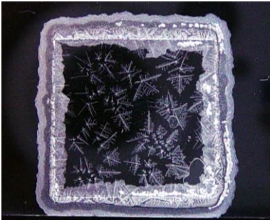
Abb. 3: Bildung einer Salzkruste am Rand des Deckglases
